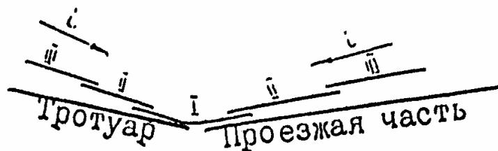
Рис. 39 Порядок укладки материала гидроизоляции
